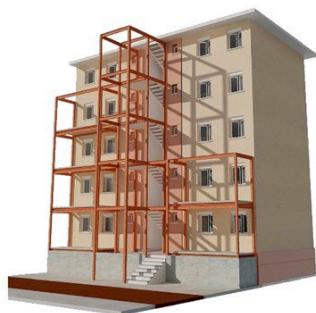
Igogailu eta galeriaren eraikuntza Construcción de ascensor y galería
