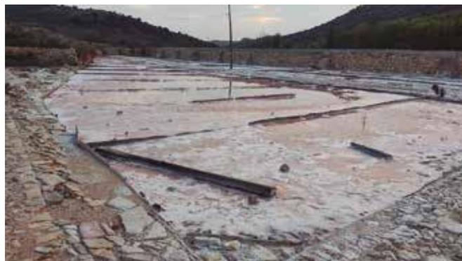
ficos, hidráulicos y técnicos. La mayoría de las explotaciones utilizan el agua de manantiales que atraviesan depósitos de sal subterráneos, aunque es frecuente bombear el agua con la ayuda de norias y bombas para aumentar la producción de sal. El agua salada se conduce a unas extensiones horizontales denominadas granjas, en las que se reparte en parcelas o eras.
